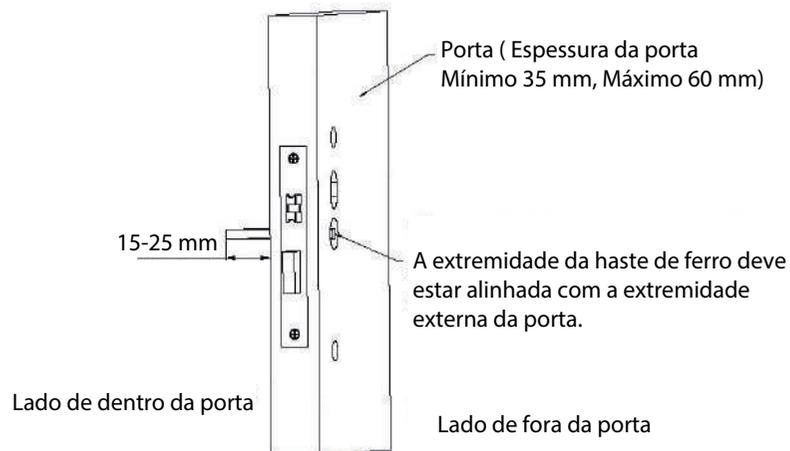
A haste de ferro deve ser inserida na fechadura de modo que sua extremidade externa esteja alinhada com a parte externa e interna da prancha da porta.
