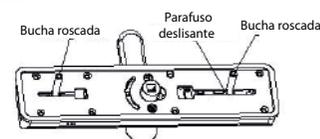
Ajuste as buchas com os parafusos deslizando na posição desejada (de acordo com a posição dos furos na porta) e aperte o tubo do parafuso.
