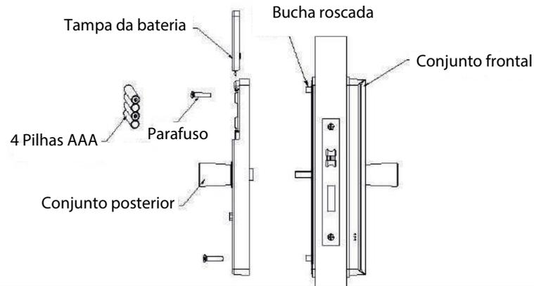
Retire a tampa da bateria. Em seguida, alinhe o conjunto posterior com os furos da bucha rosçada e fixe com parafusos.
