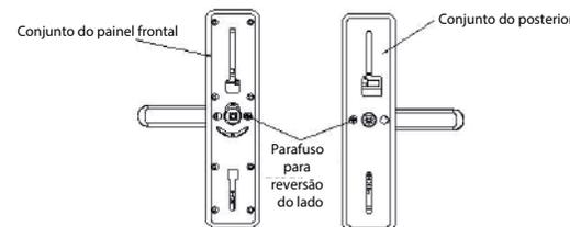
Antes da instalação, ajuste a direção da maçaneta de acordo com a direção de abertura da porta. Para reverter a direção da maçaneta; primeiro, remova o parafuso reversível; em seguida, ajuste a direção horizontal da maçaneta; por fim, aperte o parafuso novamente.
