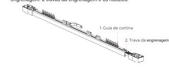
Passo 3: Faça uma marcação entre a caixa de engrenagem e a correia, conforme a imagem abaixo.
