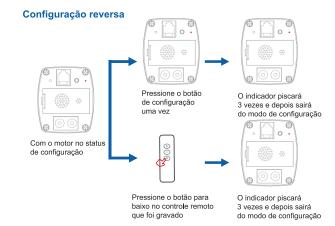
Só é eficaz quando o controle remoto em uso foi gravado! A direção de trabalho de todo o controle será invertido após a definição!
